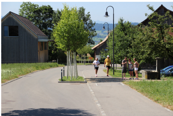
Sammelstrasse mit überfahrbarem Trottoir und punktueller Einengung, Meilen ZH
