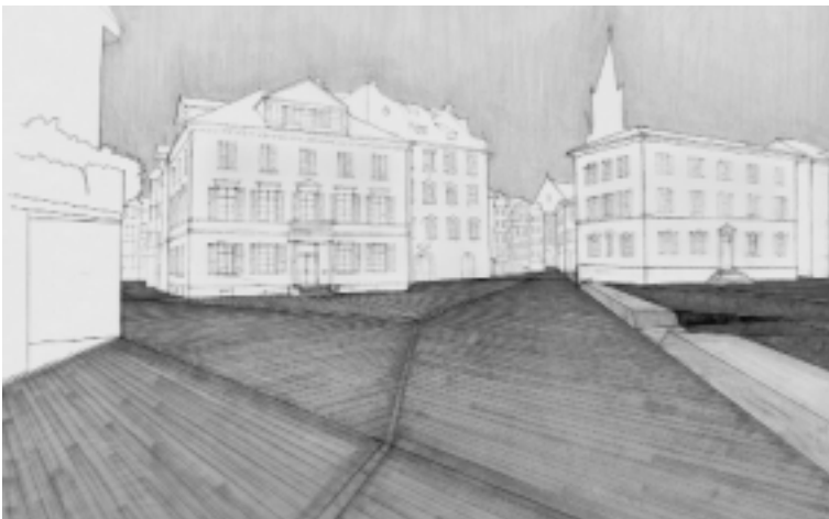
Die heutige Gestaltung der Strassenräume mit Parkplatzreihen und Trottoirs entspricht noch nicht dem Verkehrsregime einer Begegnungszone. Mit der vorgesehenen Pflasterung und Einebnung des Belages soll das Mischverkehrsregime unterstützt werden.
