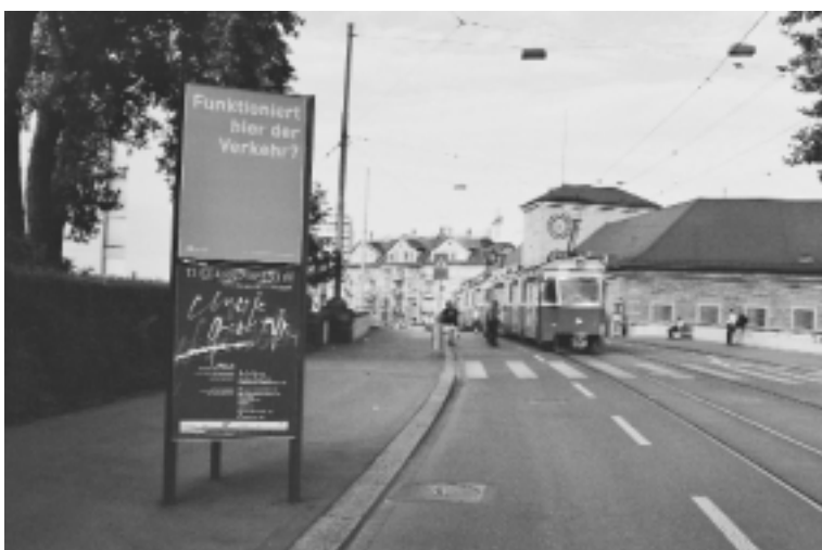
Tramstation Bahnhof Enge / Bederstrasse, Zürich: Tramhaltestellen mit Ausstieg direkt auf die Fahrbahn sind besonders gefährlich. Das zufällig hier angebrachte grüne Plakat der Zürcher Kampagne für Mobilitätskultur wirkt an diesem Ort wie Ironie.
