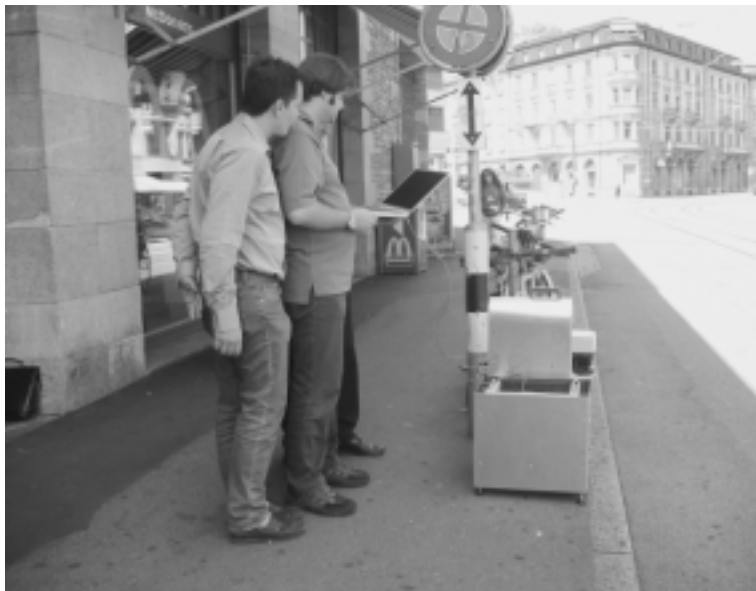
Das Lasergerät zählt und erfasst alle Verkehrsteilnehmer nach Typ und Geschwindigkeit. Zu Demonstrationszwecken wurde ein Laptop angeschlossen.
