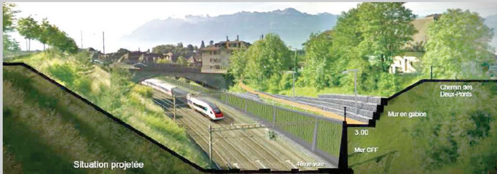
Abbildung 7: Geplantes Grünrouten-Teilstück im Geländeerschnitt Languedoc. Der neu projektierte Weg von 3m Breite schliesst eine Lücke im Fuss- und Velowegnetz. Die beengte Situation stellt eine Herausforderung für die Moderation der Koexistenz des Fuss- und Veloverkehrs dar. Die «Groupe accessibilité piétonne» GAP wurde in den Erarbeitungsprozess involviert (Bild: www.lausanne.ch/tranchee-languedoc).
