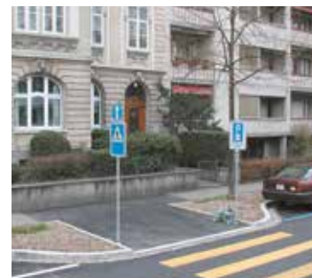
Allargamento laterale del marciapiede (restringimento della carreggiata).
