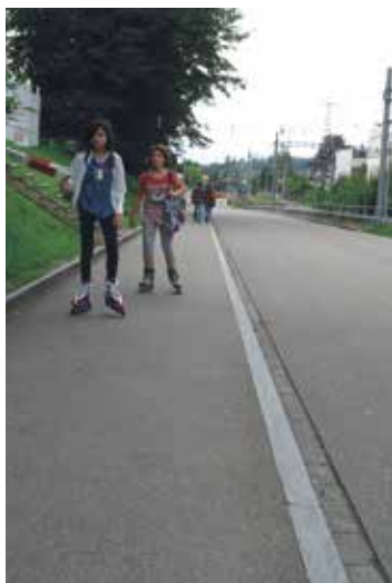
Marciapiede separato dalla carreggiata con uno zoccolo.
